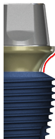
Рис. 5. S-образный абатмент позволяет создать «двойное переключение платформ».
