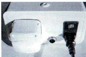
Вставьте сетевой шнур в разъем, находящийся сзади на блоке управления.
