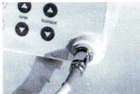
Пожалуйста, подключите мотор к разъему. Проверьте совпадение контактов соединения мотора с разъемом. После чего заверните фиксирующее кольцо до упора.
