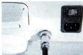
Пожалуйста, вставьте разъем ножной педали. Проверьте совпадение контактов соединения разъема педали с разъемом блока управления. После чего заверните фиксирующее кольцо до упора.
